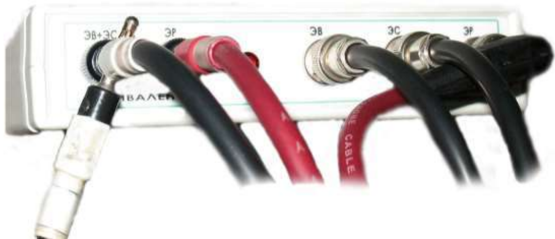
Рисунок 4 - Соединение разъемов для электродов с гнездами встроенного эквивалента
